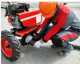
Соединить свободный конец прочистного стержня с валом отбора мощности на приводе. Приступить к работе
